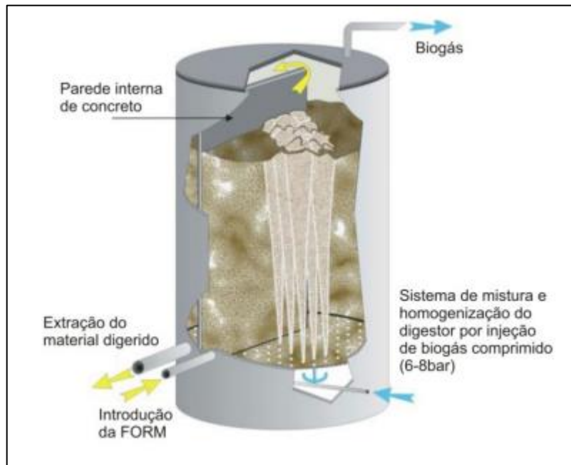
Figura 7 - Representação do Sistema Valorga
